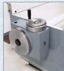
Comando rotazione tavola porta pezzi Work table angle setting by gear box
