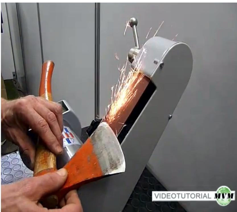
Führen Sie die Messerschneide mit einem leichten Druck an der oberen flexiblen Zone des Schleifpapiers entlang um das Messer auf beiden Seiten zu schärfen. Das Schleifpapier passt sich dem Winkel der Messerschneide an. In der unteren starren Zone können Sie den Winkel des Messerschliffs selbst bestimmen.
