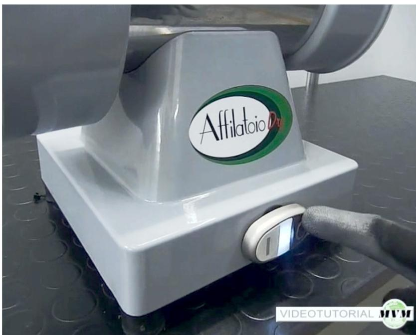
Zum Ausschalten der Maschine drücken Sie die OFF-Taste.
