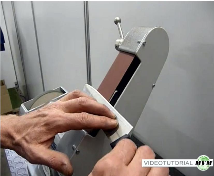
Führen Sie die Messerschneide mit einem leichten Druck über die untere starre Zone des Schleifpapiers um den Winkel der Messerschneide zu schärfen. Der Winkel der Messerschneide wird durch die Position am Schleifpapier bestimmt.
