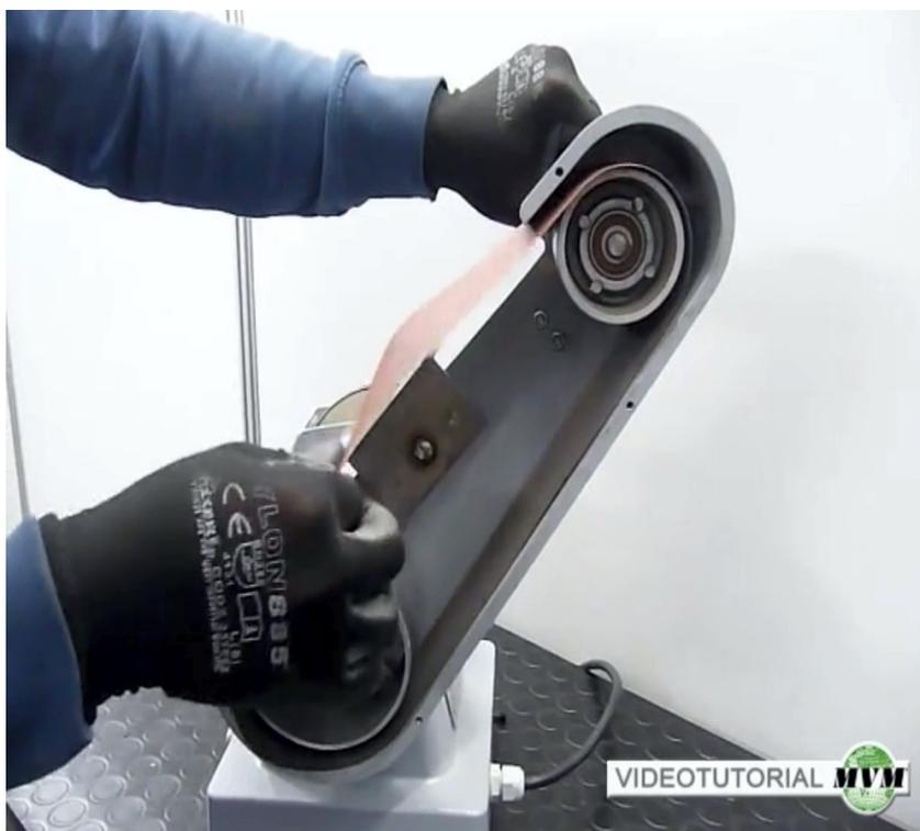
Entfernen Sie das Schleifpapier und lassen dann den Hebel wieder los.
