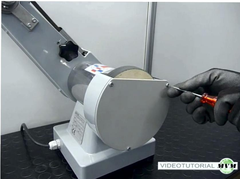
Entfernen Sie die Schrauben und die Abdeckung.
