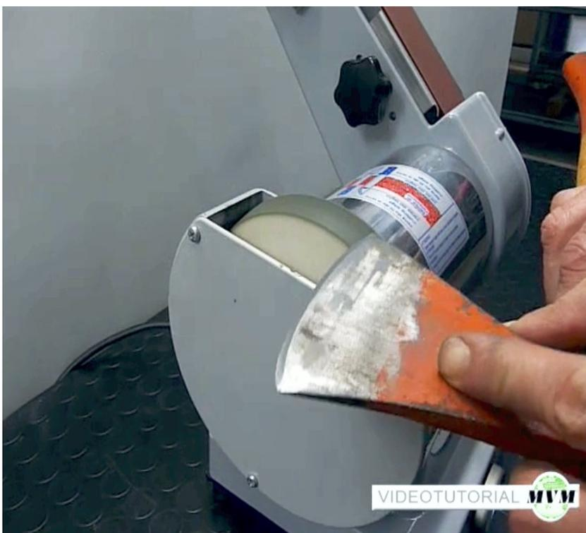
Führen Sie das Messer mit leichtem Druck über die Polierscheibe um das Messer auf beiden Seiten zu polieren.
