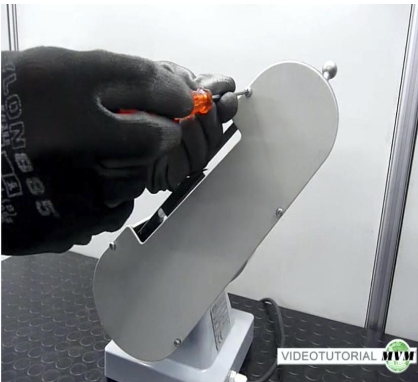
Positionieren Sie nun die Abdeckung wieder und ziehen Sie die vier Schrauben fest.
