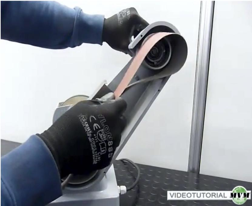
Drehen Sie den Hebel, legen Sie das neue Bandschleifpapier ein und lassen Sie den Hebel wieder los um es wieder zu spannen.
