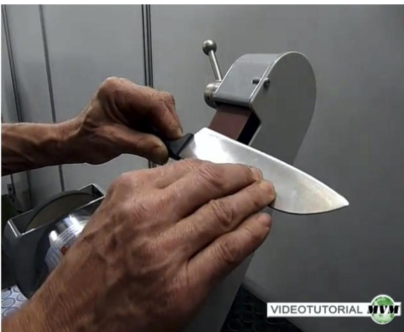
Führen Sie die Messerschneide mit einem leichten Druck über die obere flexible Zone des Schleifpapiers. Das Schleifpapier passt sich dem Winkel der Messerschneide an.
