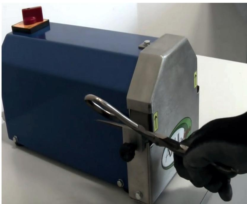
Appoggiare ogni lama della forbice contro al riferimento inclinato a 50° fino a contatto con la mola ed effettuare 1-2 passate max per ciascuna lama.
