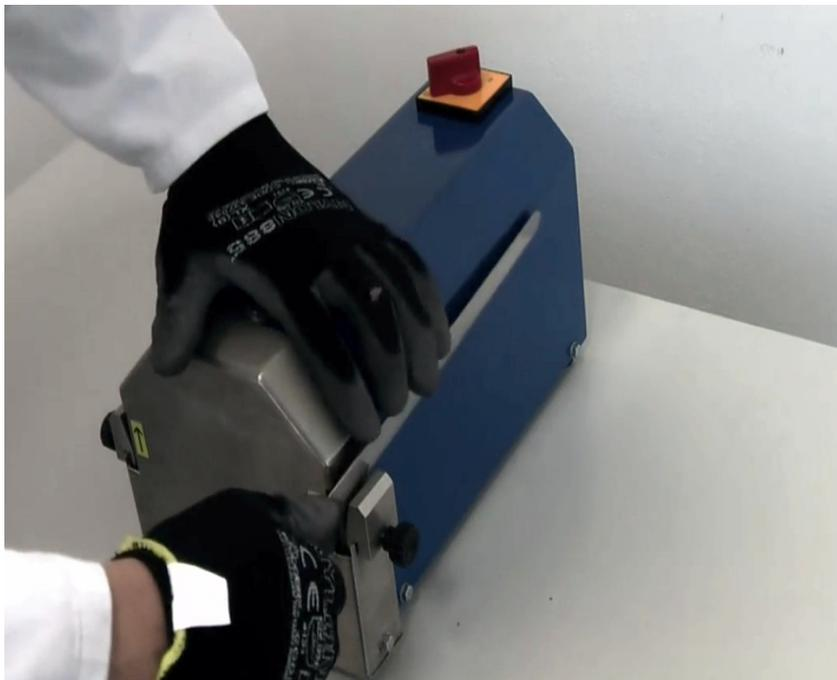
Ruotare l'interruttore in posizione 2, appoggiare la lama del coltello sul riferimento angolare dx a 30° fino a contatto con la mola ed effettuare 2-3 passate max di affilatura.
