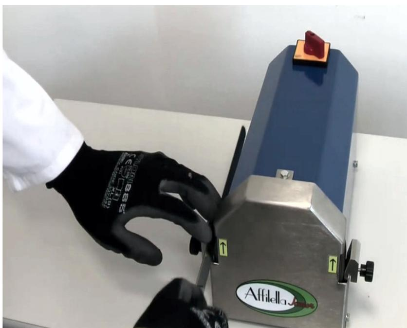
Ruotare l'interruttore in posizione 1, appoggiare la lama del coltello sul riferimento angolare sx a 30° fino a contatto con la mola ed effettuare 2-3 passate max di affilatura.
