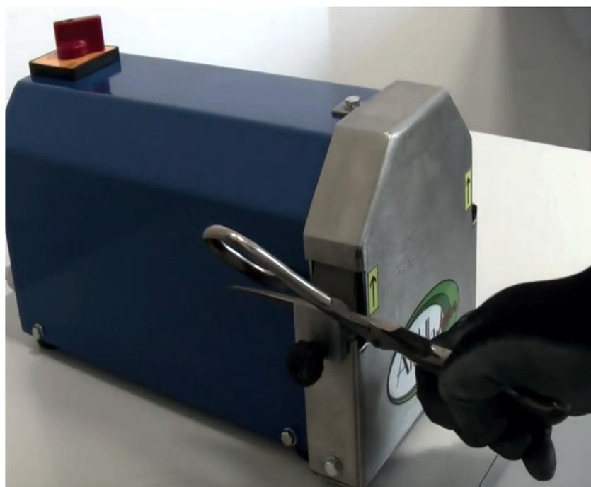
Разместить каждое лезвие ножниц напротив наклонённого на 50° упора до соприкосновения его со шлифкругом и пропустить каждое лезвие 1-2 раза максимум.
