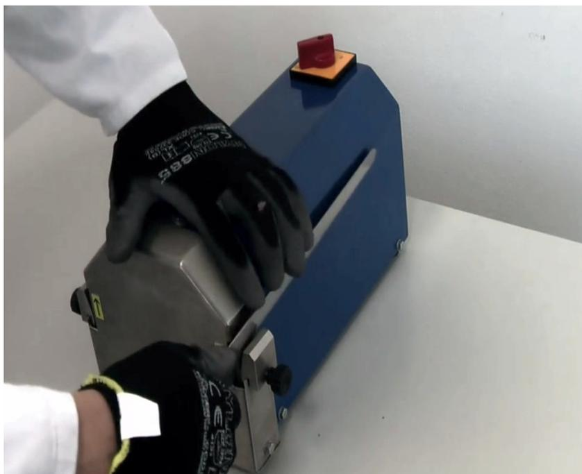
Повернуть переключатель в положение 2, положить лезвие ножа на правый 30° упор до его соприкосновения со шлифкругом и пропустить нож 2-3 раза максимум для заточки.
