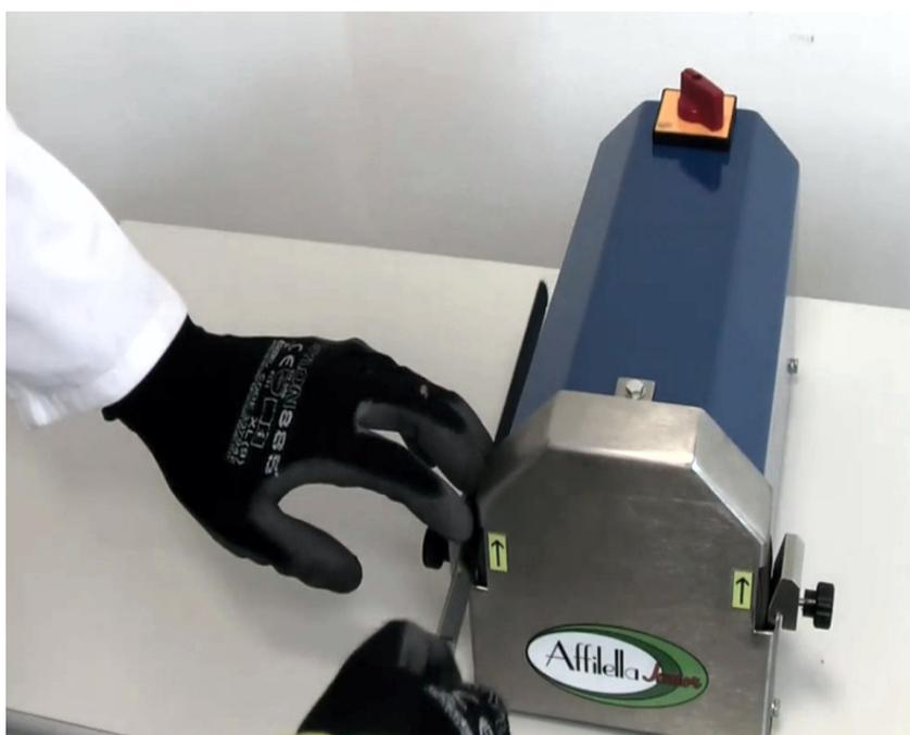
Повернуть переключатель в положение 1, положить лезвие ножа на левый 30° упор до соприкосновения со шлифкругом и пропустить нож 2-3 раза максимум.
