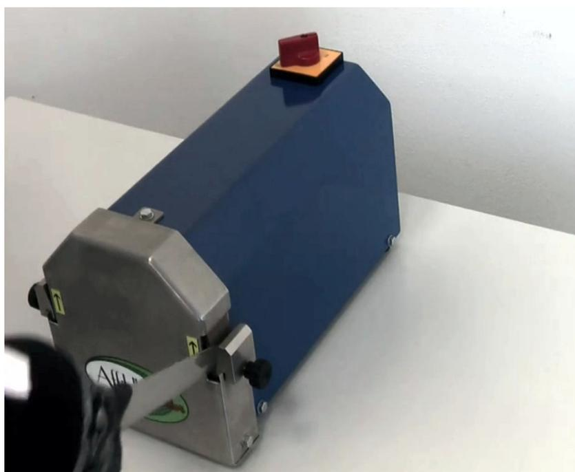
При заточке ножей с закруглённым концом следовать вручную за формой лезвия при вытаскивании ножа из станка с обеих его сторон.
