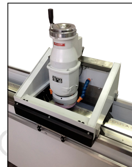
Discesa motorizzata del mandrino Descente motorisée du mandrin Descenso motorizado del mandril
