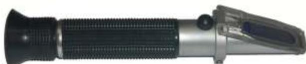
Оптический инструмент, позволяющий определить процентное содержание масляной эмульсии внутри охлаждающей жидкости. Работает используя принцип отклонения световых лучей, проникающих через образец жидкости.
