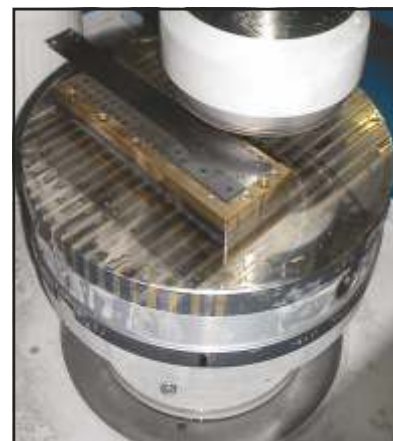
Piano magnetico a campo aperto Open field magnetic work surface Magnettisch für HM Werkstücke
