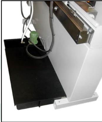
Vasca esterna External coolant tank with pump Externer Kühlmitteltank mit Pumpe
