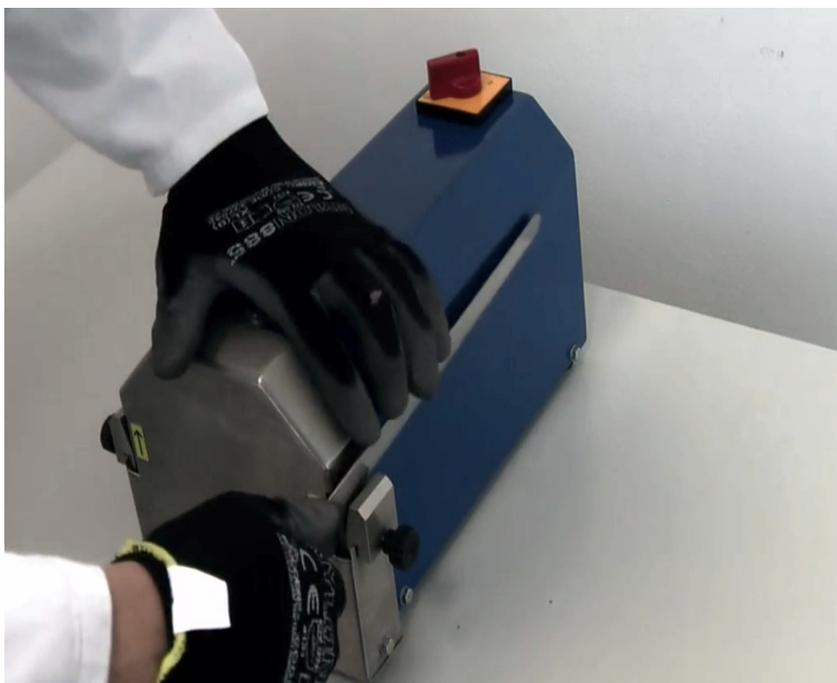
Gire el interruptor a la posición 2, apoye la hoja del cuchillo sobre la referencia angular derecha a  $30^\circ$  hasta el contacto con la muela. Efectuar máximo 2-3 pasadas de afilado.
