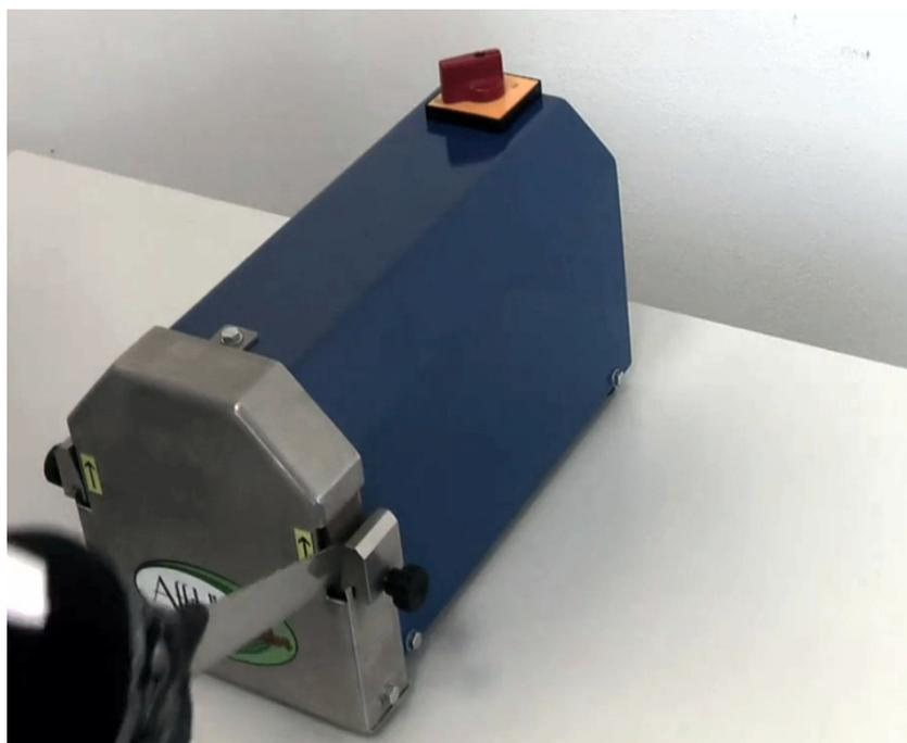
Para cuchillos con punta curvada, afile por los dos lados la hoja de la cuchilla siguiendo de manera manual la geometría del cortante, durante la extracción del cuchillo de la máquina.
