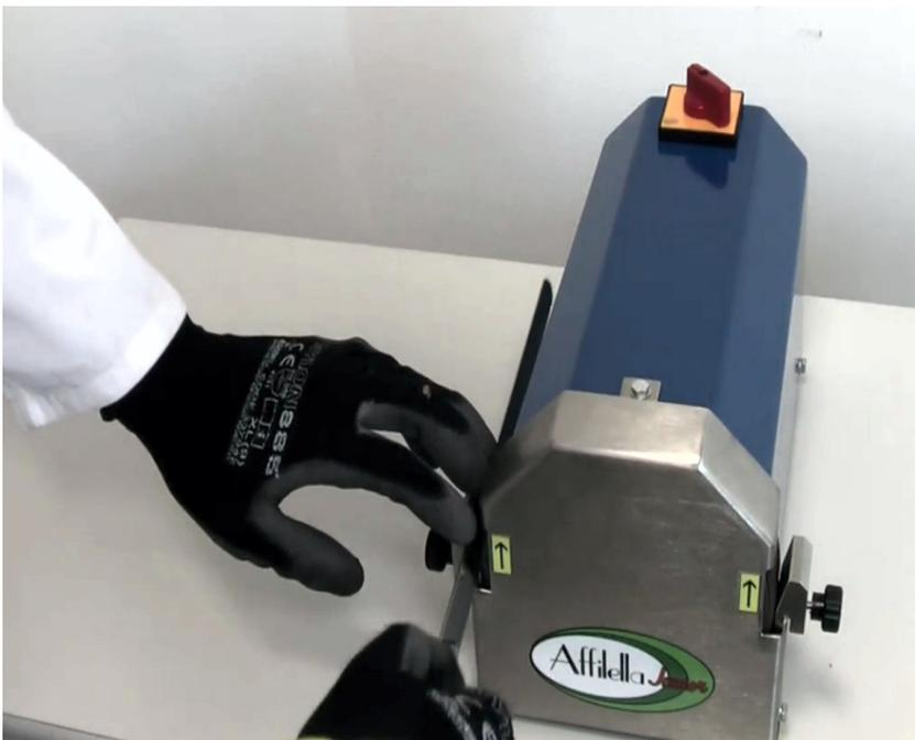
Gire el interruptor a la posición 1, apoye la hoja del cuchillo sobre la referencia angular izquierda a  $30^\circ$  hasta el contacto con la muela. Efectuar máximo 2-3 pasadas de afilado.
