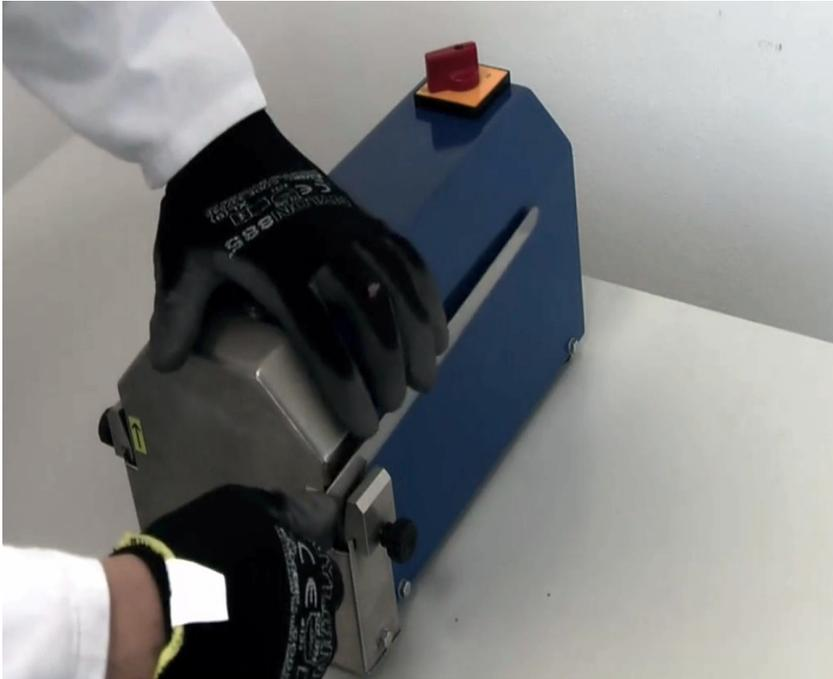
Tourner l'interrupteur sur la position 2, poser la lame du couteau sur la cale de référence angulaire droit à 30° jusqu'au contact avec la meule et effectuer 2 ou 3 passages maximum d'affûtage.
