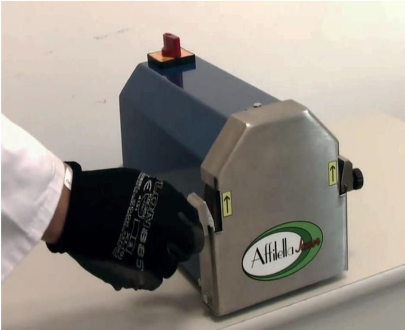
Positionner les 2 cales de référence à 30° sur le carter de protection de la meule, l'une à droite et l'autre à gauche de celle-ci.
