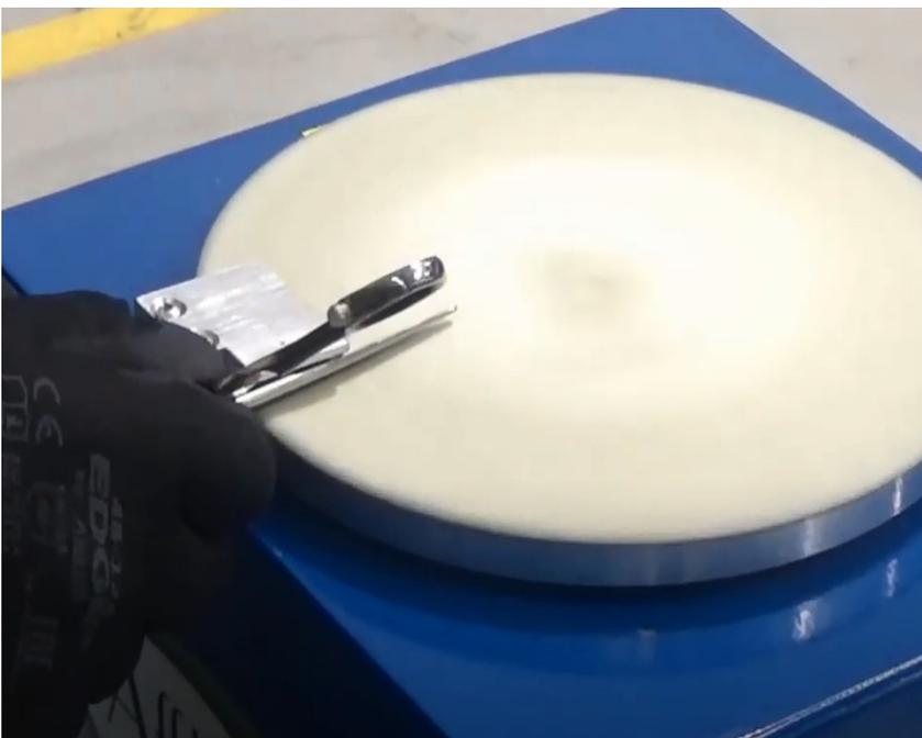
Placer la lame intérieure des ciseaux sur le bloc de référence incliné à 40 °, appuyer légèrement la lame contre le tissu et déplacer la lame vers l'avant et vers l'arrière lentement et à plusieurs reprises.
