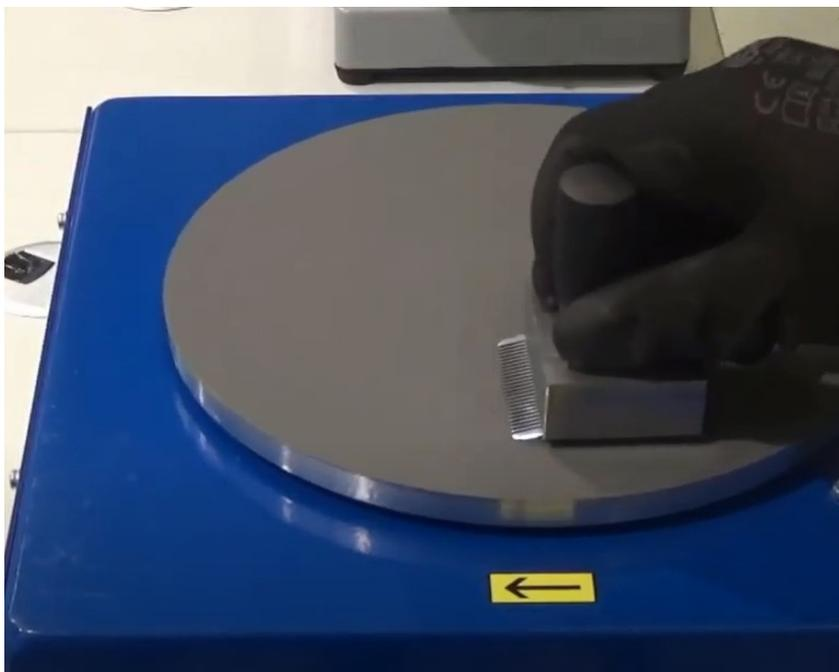
Appuyer la tête de coupe sur le disque abrasif en rotation et exercer une légère pression manuellement.
