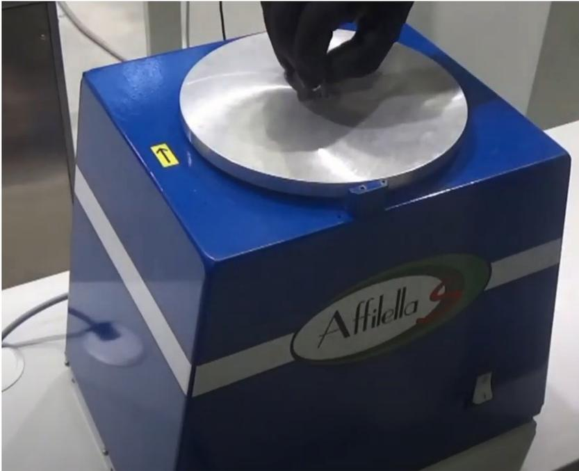
Placer la table rotative en aluminium et fixez-la avec des vis M4X22.
