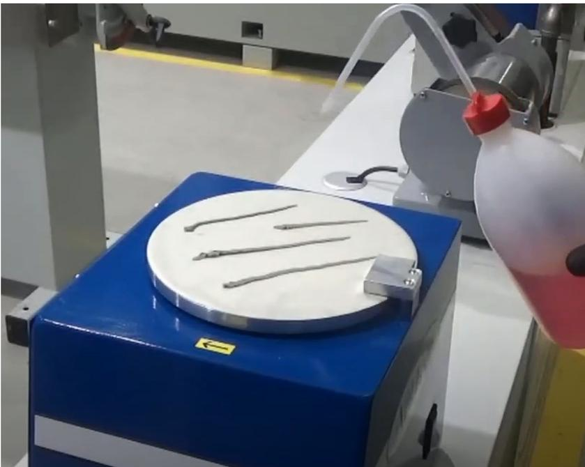
Humidifier le tissu avec de l'alcool pour étaler la pâte abrasive diamantée et distribuer la pâte manuellement sur le tissu.
