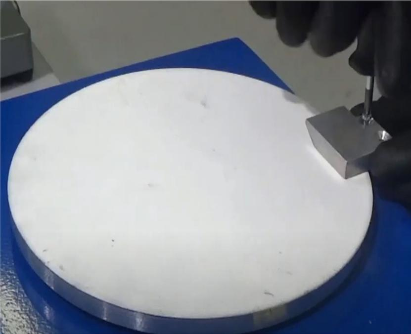
Fixer le bloc de référence incliné ( $40^\circ$ ) dans le support approprié avec les vis M4X12.
