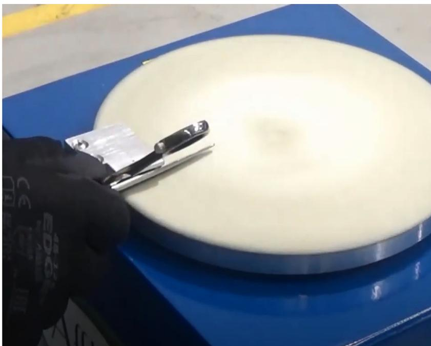
Appoggiare la parte interna della lama della forbice sul riferimento inclinato a  $40^\circ$ , premere leggermente la lama verso il panno e muovere lentamente e ripetutamente la lama avanti e indietro.
