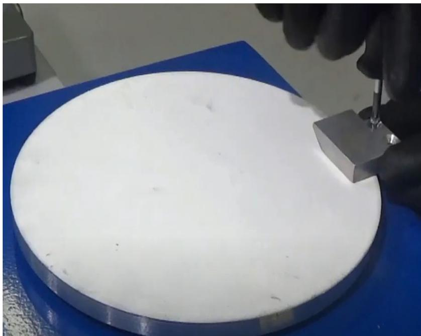
Fissare il riferimento inclinato ( $40^{\circ}$ ) all'apposito supporto con le viti M4X12.
