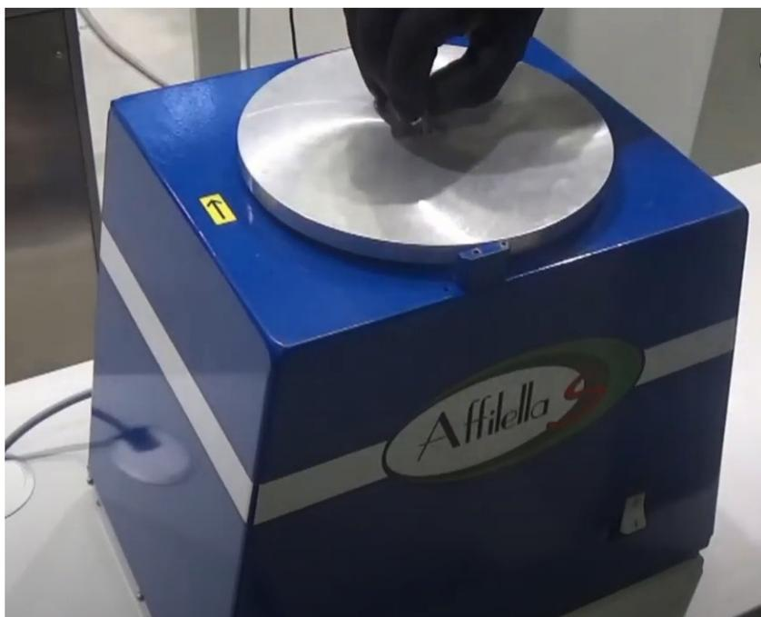
Inserire la tavola rotante in Alluminio e fissarla tramite la vite M4X22.
