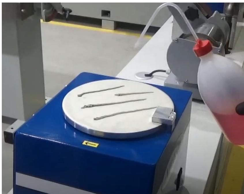
Inumidire il panno con alcol per uniformare la pasta diamantata e distribuire la pasta manualmente sul panno.
