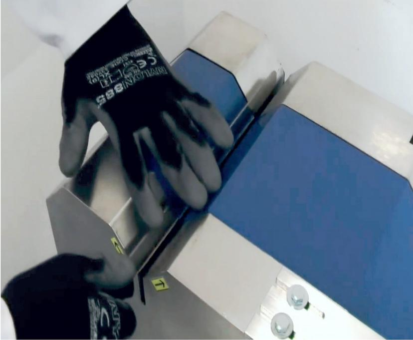
Legen Sie die Küchenmesser von oben in den Schlitz, bis die Klingen in Kontakt mit den Schleifscheiben kommen, und ziehen Sie das Messer 2-3 mal über die Schleifscheiben, schließlich entnehmen Sie die Messer nach vorne aus dem Schleifschlitz.
