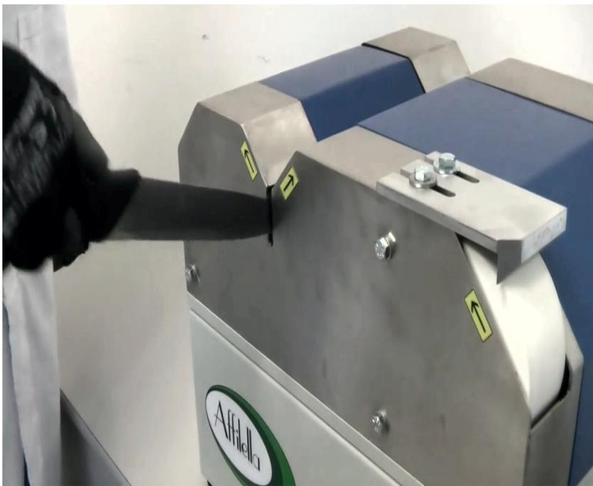
Messer mit gebogener Spitze schärfen Sie indem Sie der Geometrie der Schneide folgen beim Herausziehen des Messers aus dem Schleifschlitz.
