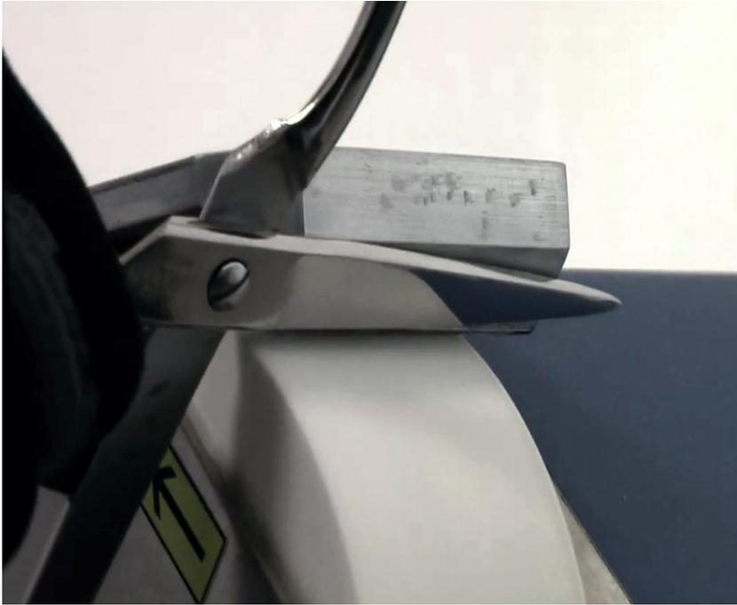
Legen Sie jede Scherenklinge gegen die Ausrichtfläche auf 45 ° bis sie in Kontakt mit der Schleifscheibe kommt, dann ziehen Sie jede Klinge 1-2 mal über die Schleifscheibe.
