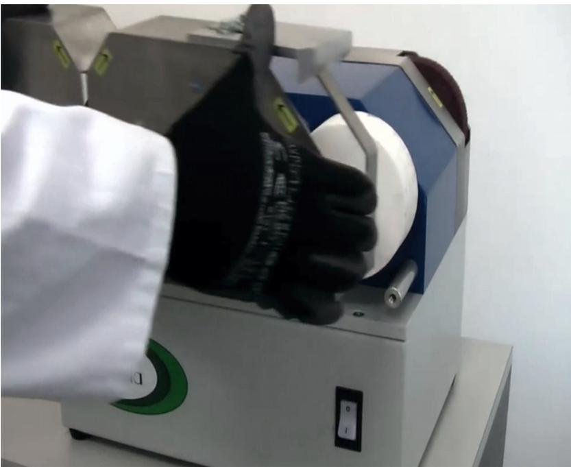
Nach dem Austausch der Schleifscheiben, setzen Sie die Schutzabdeckung wieder in Ihre ursprüngliche Position und ziehen die 4 Schrauben fest.
