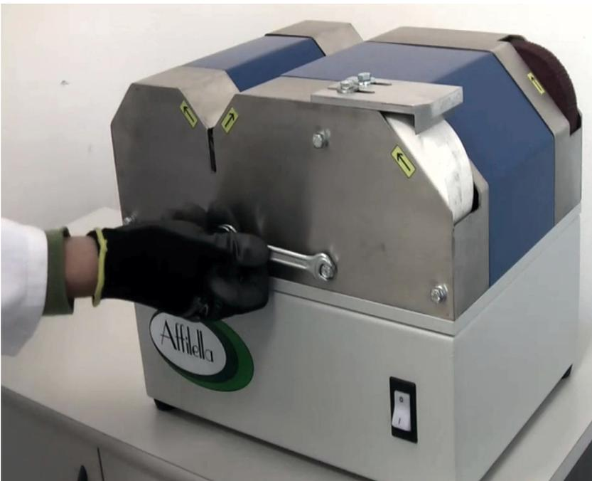
Lösen Sie die 4 Schrauben auf der oberen Schutzabdeckung.
