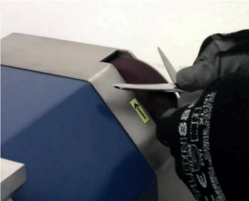
Zum Entgraten und Polieren ziehen Sie jede Scherenschneide 1-2 mal über die Polierscheibe.
