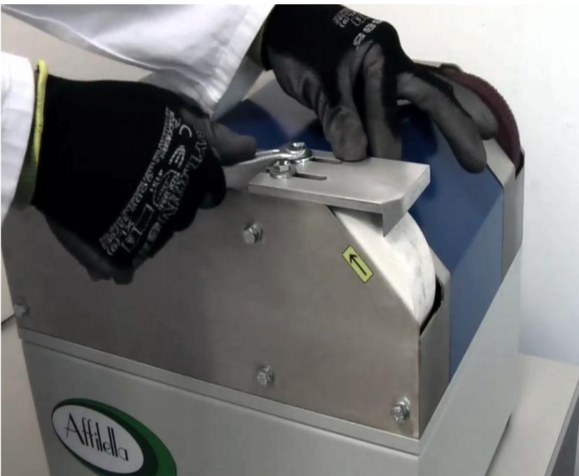
Entsprechend der Abnutzung der Schleifscheibe sollten Sie den Referenz Anschlag näher an die Schleifscheibe eingestellt werden. Dazu lösen Sie die 2 Schrauben verstellend den Anschlag und ziehen dann die Schrauben wieder fest. Mit einem Blatt Papier können Sie den den Abstand zwischen dem Referenzanschlag und der Schleifscheibe überprüfen.
