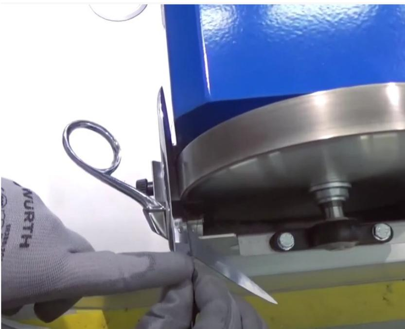
Colocar el interruptor en la posición 1, apoyar la hoja de la tijera en la referencia angular izquierda a 50° hasta que esté en contacto con la muela y realizar 2-3 pasadas máx de afilado.
