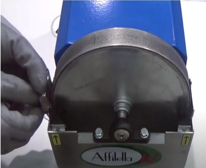
Colocar la referencia a 50° sobre el cárter, en la posición a izquierda de la muela.
