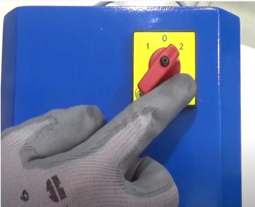
Colocar el interruptor en la posición 2 para activar la rotación de la muela en el sentido antihorario. Trabajar exclusivamente en la posición derecha de la máquina.
