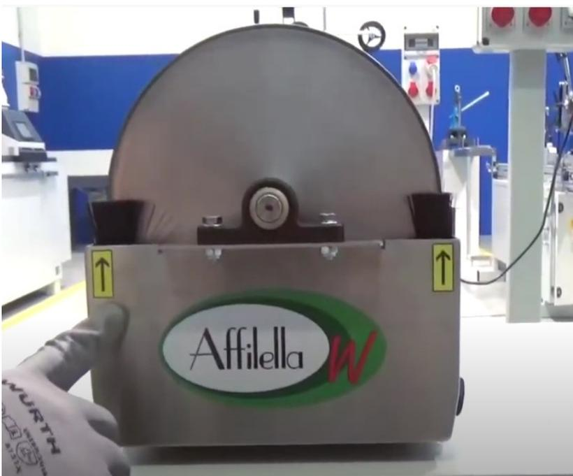
Colocar el interruptor en la posición 1, apoyar la hoja del cuchillo en la referencia angular izquierda a 15° hasta que esté en contacto con la muela y realizar 4-5 pasadas máx de afilado.
