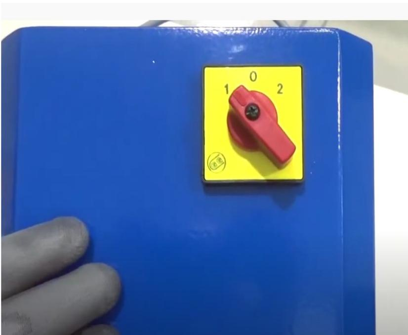
Colocar el interruptor en la posición 1 para activar la rotación de la muela en el sentido horario. Trabajar exclusivamente en la posición izquierda de la máquina.
