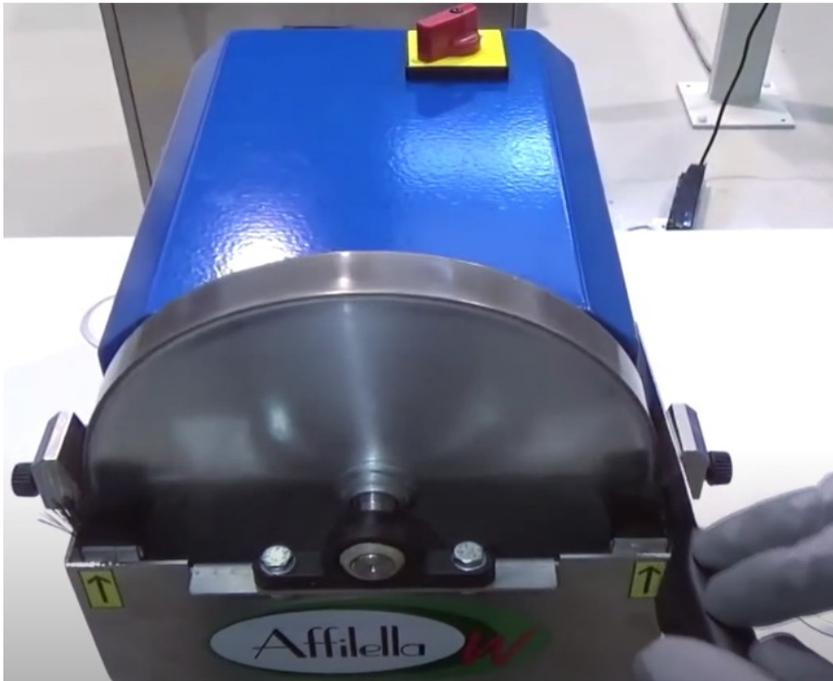
Colocar el interruptor en la posición 2, apoyar la hoja del cuchillo en la referencia angular derecha a  $15^\circ$  hasta que esté en contacto con la muela y realizar 4-5 pasadas máx de afilado.
