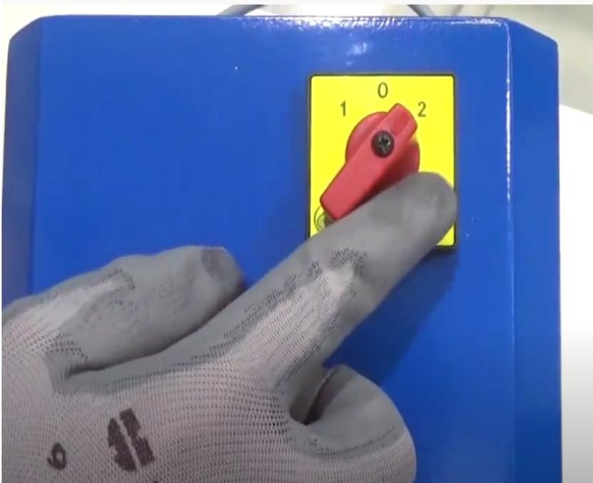
Tourner l'interrupteur sur la position 2 pour la rotation de la meule dans le sens antihoraire. Opérer uniquement sur le côté droite de la machine.
