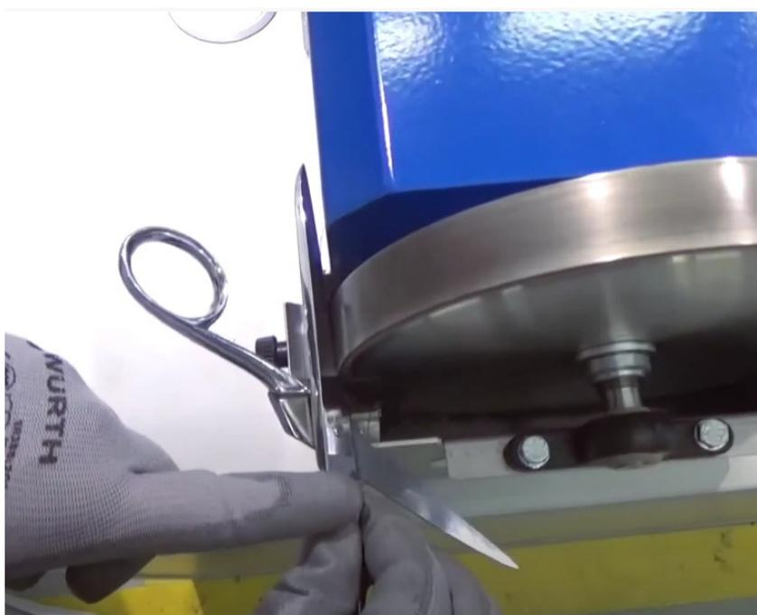
Tourner l'interrupteur sur 1, placer la lame des ciseaux contre la cale d'appui incliné à 50° jusqu'à qu'elle touche la meule et passer chaque lame au maximum 1 ou 2 fois.
