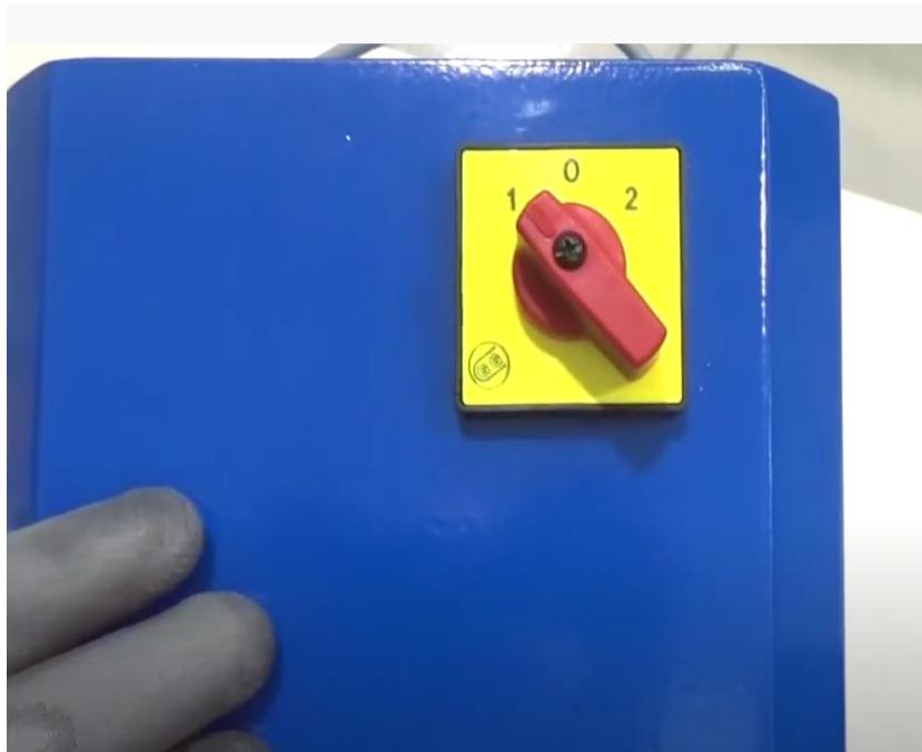
Ruotare l'interruttore in posizione 1 per rotazione della mola in senso orario.
