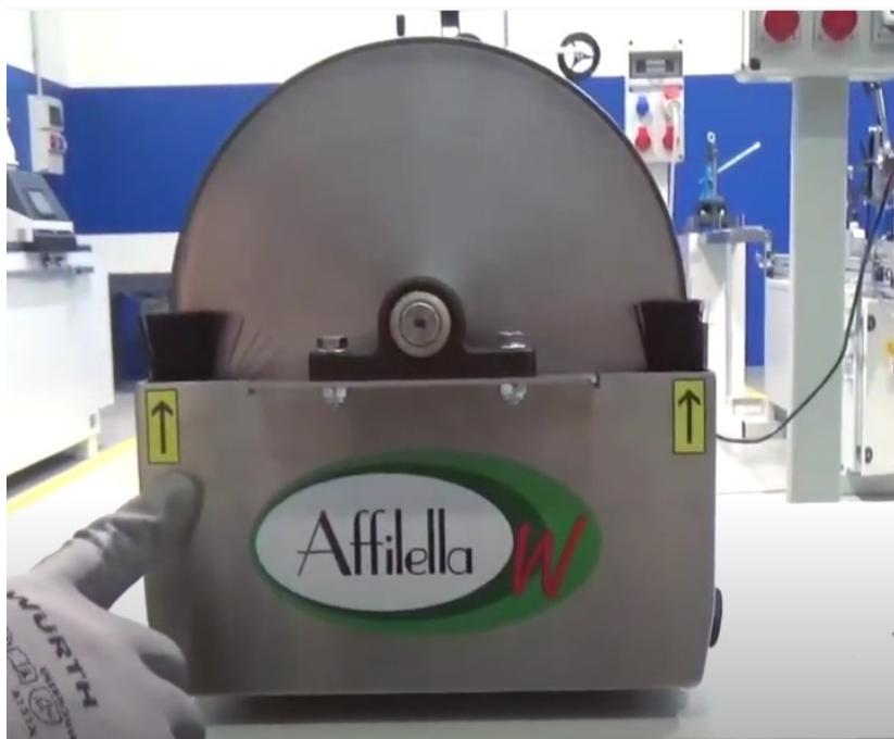
Ruotare l'interruttore in posizione 1, appoggiare la lama del coltello sul riferimento angolare sx a 15° fino a contatto con la mola ed effettuare 4-5 passate max di affilatura.
