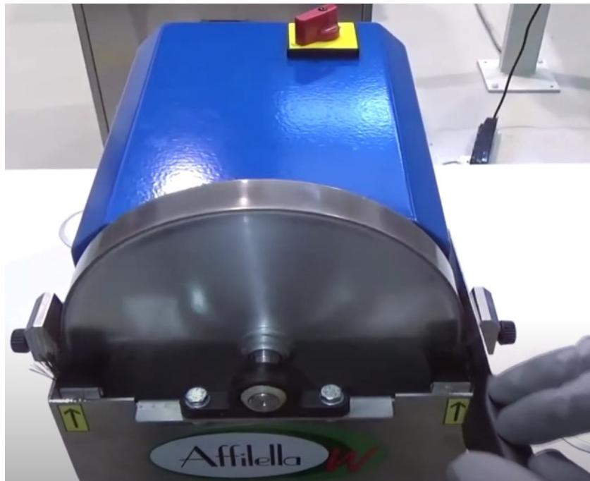
Ruotare l'interruttore in posizione 2, appoggiare la lama del coltello sul riferimento angolare dx a 15° fino a contatto con la mola ed effettuare 4-5 passate max di affilatura.
