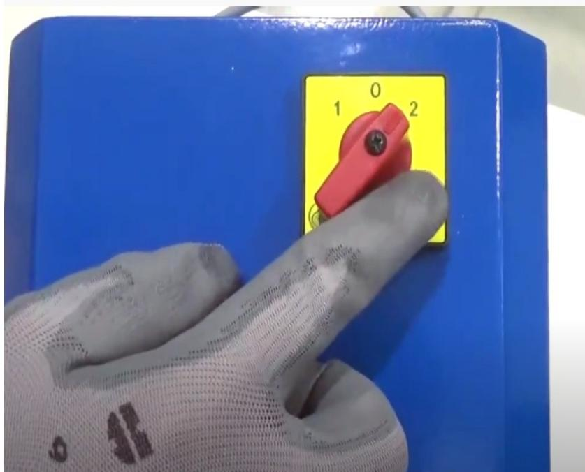
Ruotare l'interruttore in posizione 2 per rotazione della mola in senso antiorario.
