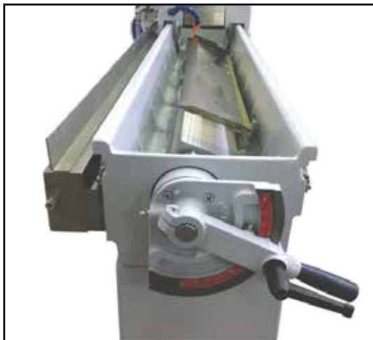
Piano magnetico rotante 0°-90° Magnetic chuck 电磁卡盘
