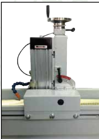
Gruppo discesa mola automatica Grinding head 磨头
