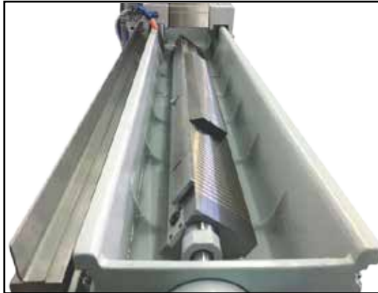
Barra per riferimento da filo Edge reference alignment bar 边缘基准尺
