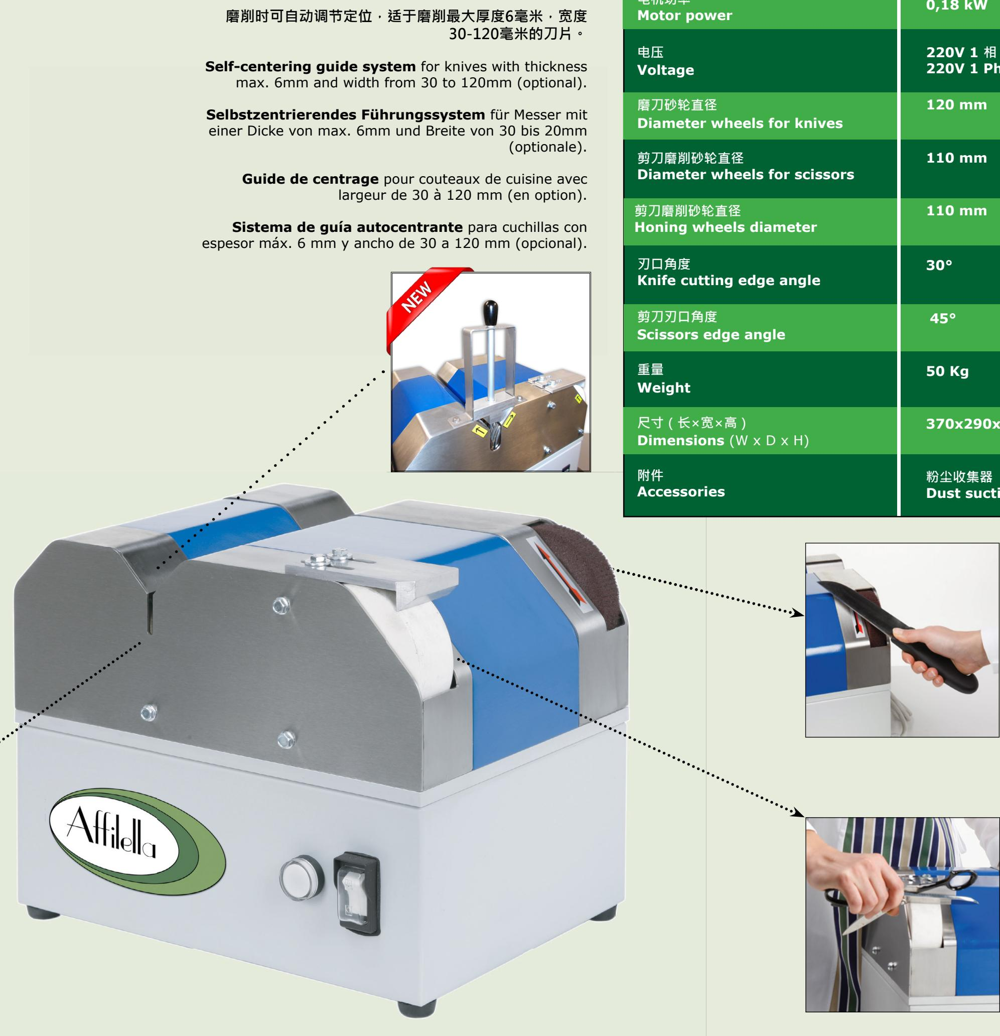
该机器包含一个铝制金属罩和喷漆底座，内含电气、机械部件，包括CBN涂层的主磨削砂轮，以及用于二次磨削（修磨）和用于剪刀研磨的砂轮。磨削时可自动调节定位，适用于磨削最大厚度6毫米，宽度30-120毫米的刀片。
