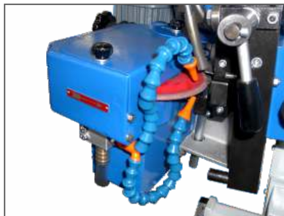
Sistema di refrigerazione Cooling system Система охлаждения
