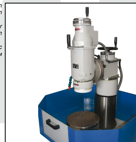
Colonna regolabile con corsa fino a 310 mm
