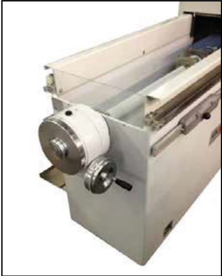
Divisore angolare per la rotazione del piano \pm 90^\circ
